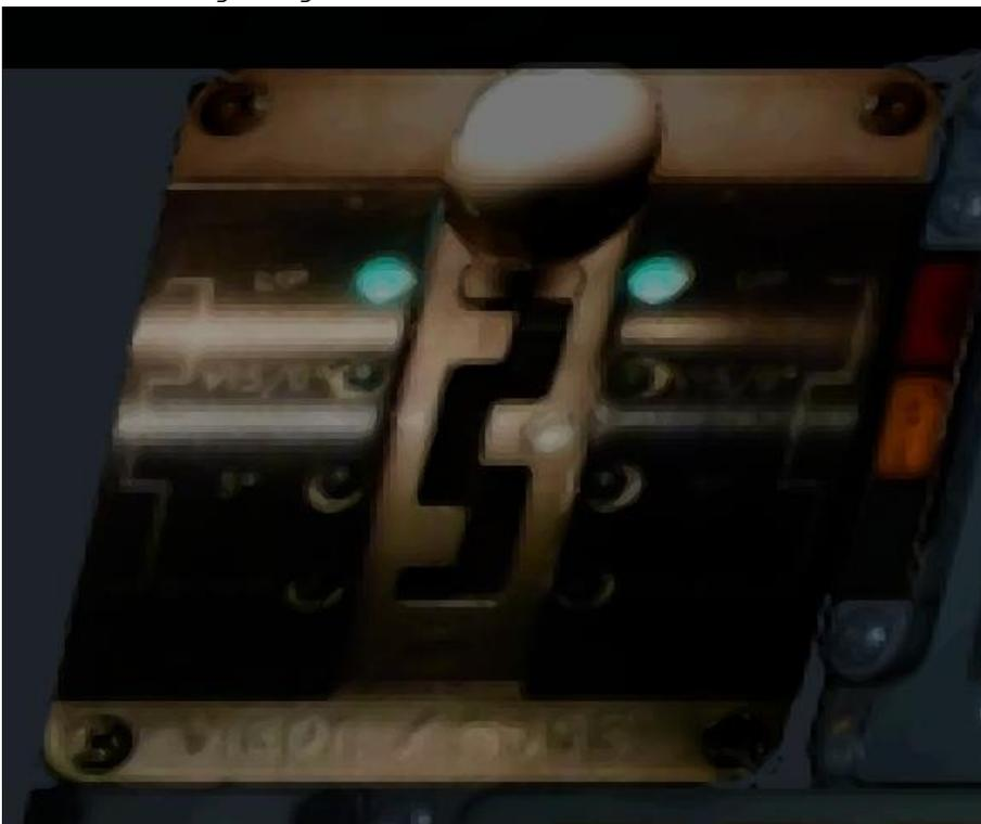
Die Flugzeugnase wird mit diesem Hebel abgesenkt.
