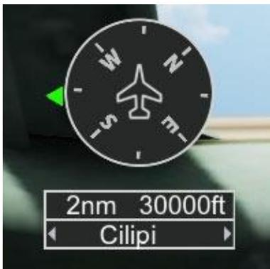
Hier bist du weit innerhalb der sicheren Zone (nur 1.5nm entfernt von der Landebahnmitte), der grüne Pfeil ist aber leicht oben links.
