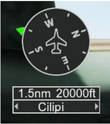
Wenn der Pfeil unterhalb ist, musst du die Querneigung etwas erhöhen, denn die Landebahnmitte befindet sich hinter dir. Erhöchst du die Querneigung nicht, wirst du zwangsläufig aus der sicheren Zone herausfliegen.
